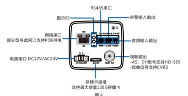
【说明】RUN灯:运行指示灯,绿色,正常上电后快闪(1秒亮、1秒灭),断电后灯灭。 LINK灯:网络状态灯,绿色,正常上电且网络物理联通后快闪(1秒亮、1秒灭),断电 或网络物理中断时灯灭。
